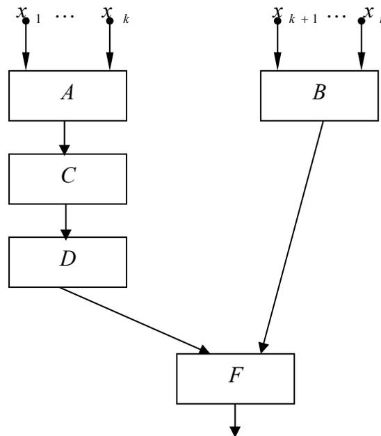
1. Блок  $A$  реализует все конъюнкции  $x_1^{\sigma_1}, \dots, x_k^{\sigma_k}$ ,  $L(A) \leq k2^k$ .
