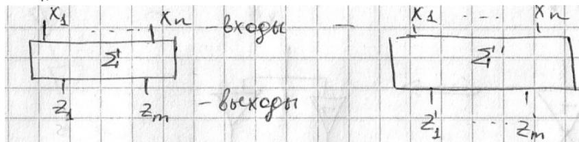
**Опр.**  $\Sigma'$  — подсхема схемы  $\Sigma$ , если
